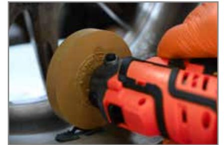
Zum Entfernen von Auswuchtklebstoff in Verbindung mit 7RS85.
